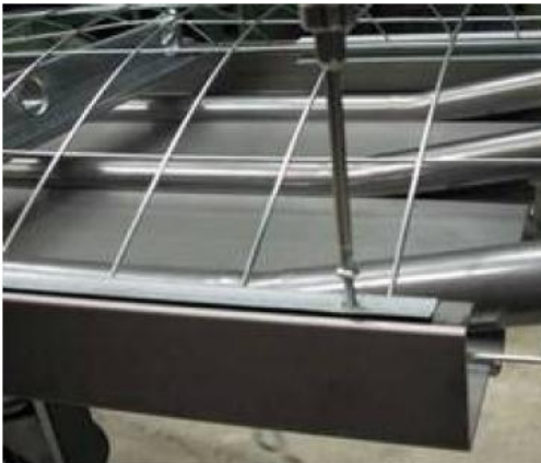
7. Зафиксировать зажим и сетку с помощью самореза
